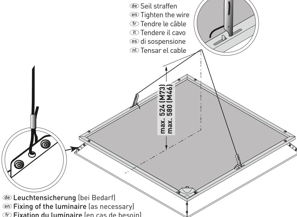
(de) Leuchtersicherung (bei Bedarf)
