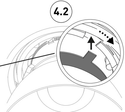
de Wallwischer **Less G3 ...WW** nach Montage ausrichten.
