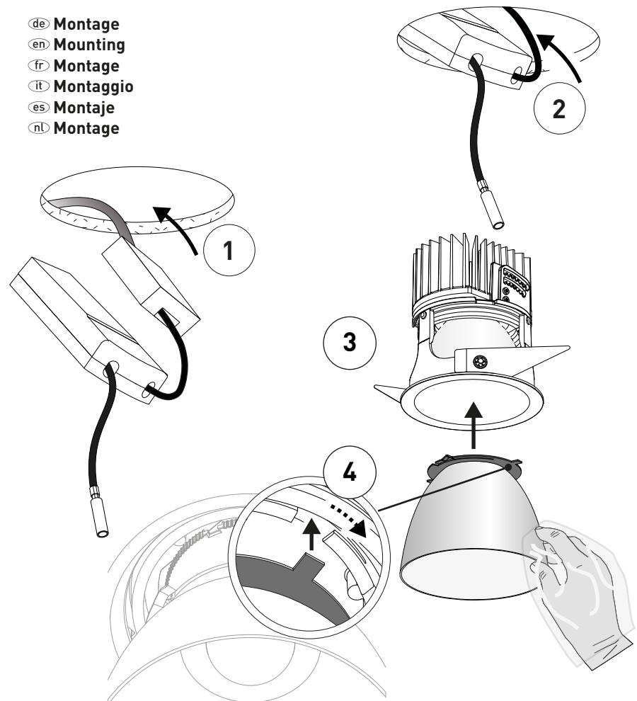
de Leuchte ist bereits vormontiert. Reflektor kann ggf auch nachträglich montiert werden. Zum Einsetzen des Reflektors benutzen Sie die Folientüte als Montagehandschuh.
