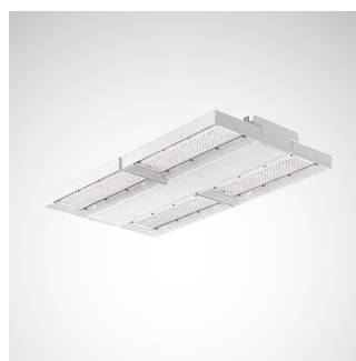
Figure 3.22 : Mirona Fit Características : Flux lumineux : 26 000 lm Durée de vie assignée : 50 000 h min. Température ambiante : 50 °C Indice de protection : IP65 Puissance raccordée : 188 watts Poids total : 7,2 kg 3 344,412 kg CO 2 e
