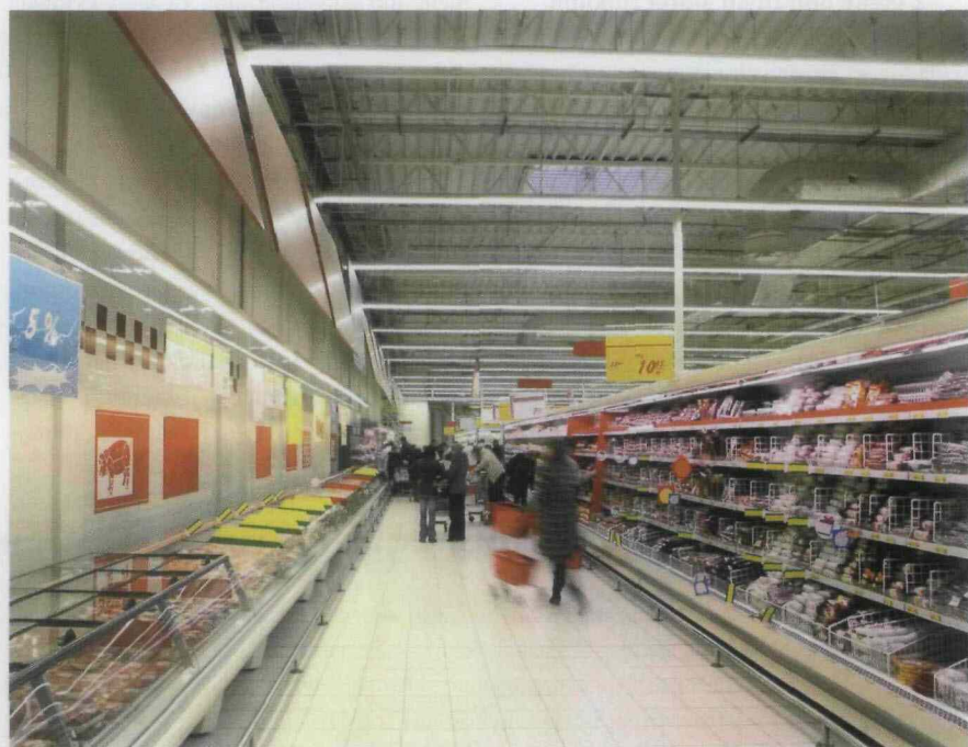
Fot. 2. Świetlówki liniowe sprawdzą się tam, gdzie istotne jest dokładne oddanie barw, np. w sklepach.
