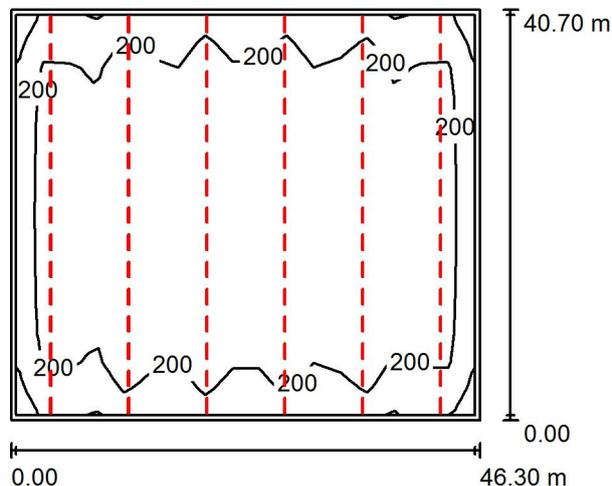
Altezza locale: 4.000 m, Altezza di montaggio: 4.000 m, Fattore di manutenzione: 0.80
