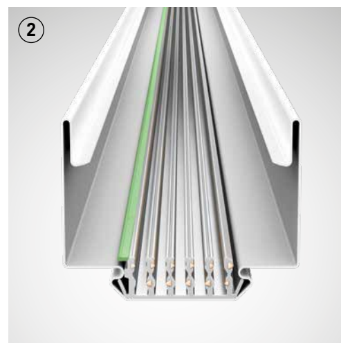
Filerie d'alimentation à 11 conducteurs 5 \times 2,5 \text{ mm}^2 + 6 \times 1,5 \text{ mm}^2 3 circuits électriques séparés 2 câbles de commande pour signal DALI 2 circuits d'éclairage de secours indépendants
