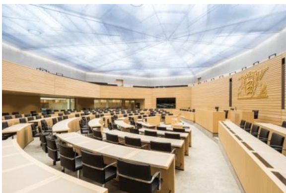
[Foto: Deutscher Lichtdesign-Preis_2018_3] Den vorher tageslichtlosen Plenarsaal überspannt jetzt eine Lichtdecke, die Tageslicht, LED-Licht oder einen Mix aus beidem bereitstellt.
