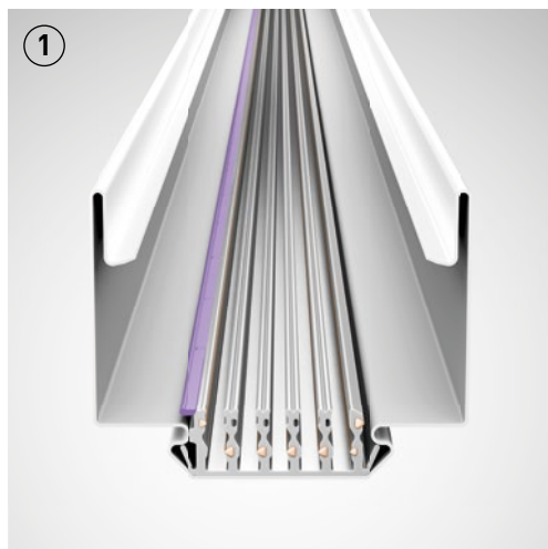
7-aderig stroomvoerend profiel 5 x 2,5 mm 2 + 2 x 1,5 mm 2 3 afzonderlijke stroomkringen 2-stuurleidingen voor DALI-sigitaal
