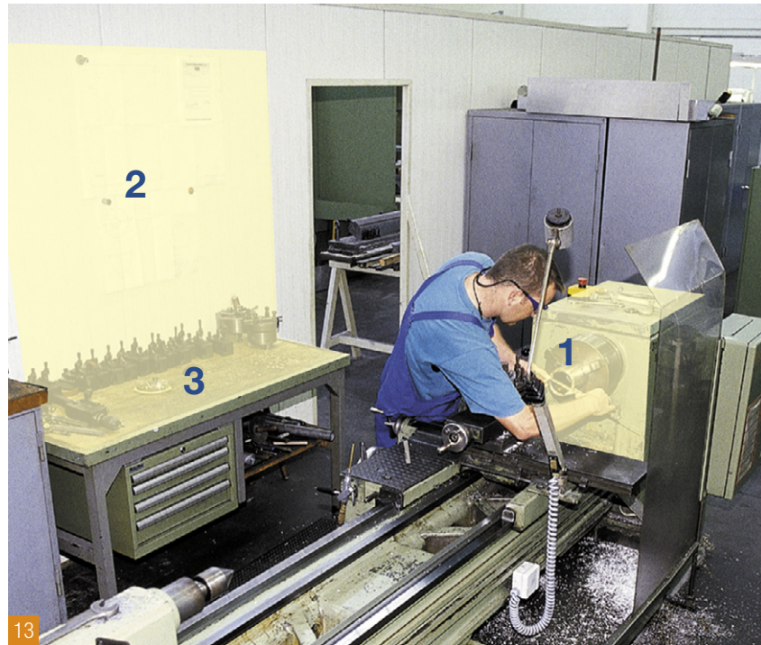
[13] Beispiel für Bereiche der Sehaufgabe entsprechend den unterschiedlichen Anforderungen am Arbeitsplatz: Drehen und Messen mittelfeiner Teile mit vertikalen und horizontalen Sehaufgaben (1), Lesen von Zeichnungen an vertikalen Flächen (2), Messen am Werkstück und Ablage der Werkzeuge (3)
