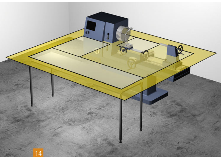
[14] Mehrere Bereiche der Sehaufgabe an einer Drehbank, die zu einem Bereich des Arbeitsplatzes (hell- und mittelgelb) zusammengefasst sind. Der Streifen des Umgebungsbereichs beträgt mindestens 0,5 m (dunkelgelb).
