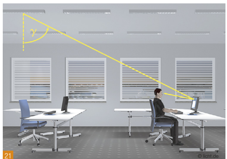
[21] Für Bildschirme mit einer Hintergrundleuchtdichte L > 200 \text{ cd/m}^2 (typisch für Büros mit guter und sehr guter Tageslichtversorgung und für Flachbildschirme, die an die helle Raumsituation angepasst sind) sind Leuchten-Leuchtdichten bis 3.000 \text{ cd/m}^2 zulässig.
