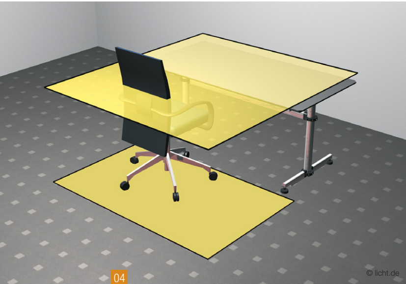
[04] Der Bereich des Arbeitsplatzes setzt sich aus den Arbeitsflächen (hellgelb) und Bewegungsflächen (mittelgelb) sowie allen dem unmittelbaren Fortgang der Arbeit dienenden Stellflächen zusammen (ASR A3.4). Typische Größe: 1,8 m x 1,8 m
