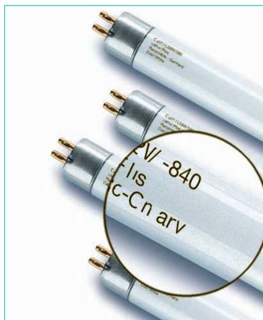
Abbildung 13 Kennzeichnung der Lampen hinsichtlich Farbwiedergabe und Lichtfarbe durch dreiziffrigen Code. Der Code 840 bedeutet: 8 – Farbwiedergabeindex R_a \geq 80 (gute Farbwiedergabe), 40 – Farbtemperatur 4000 K (neutralweiße Lichtfarbe)
